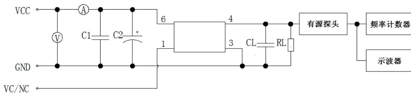
备注:  $C1=0.1\mu\text{F}$ ;  $C2=47\mu\text{F}$ ;
